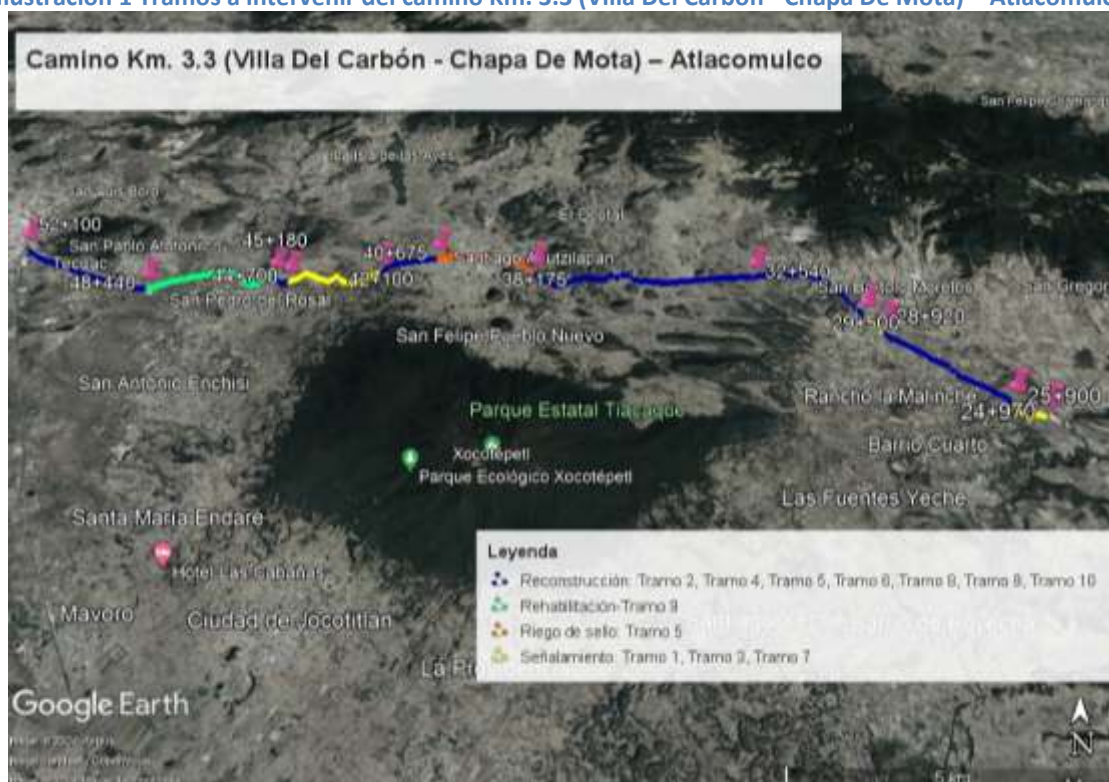
Ilustración 1 Tramos a intervenir del camino Km. 3.3 (Villa Del Carbón - Chapa De Mota) – Atlacomulco
